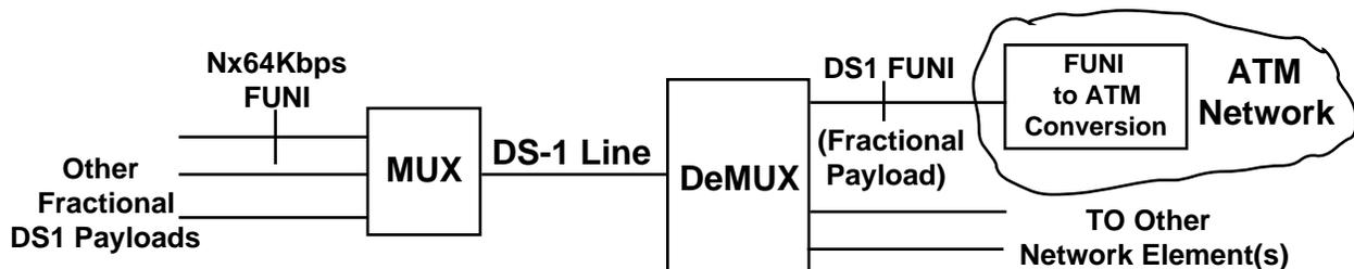
**Figure 2.2b Example of Multiplexing/Grooming a Fractional DS1 FUNI**
