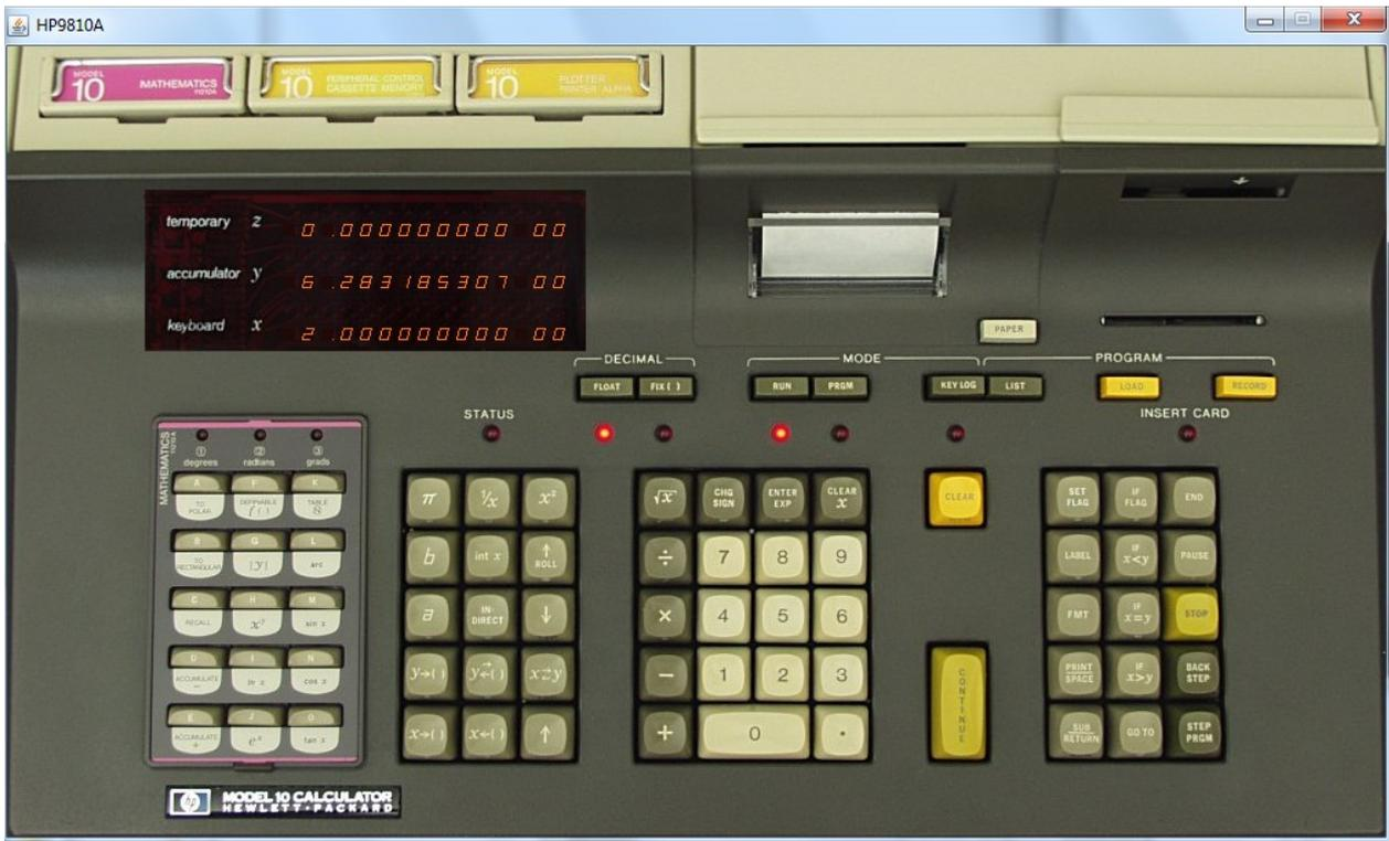
Diese Rechnersysteme arbeiten in der sog. Umgekehrten Polnischen Notation (UPN; engl: RPN). D.h. erst die Operanden, dann die Operation.
