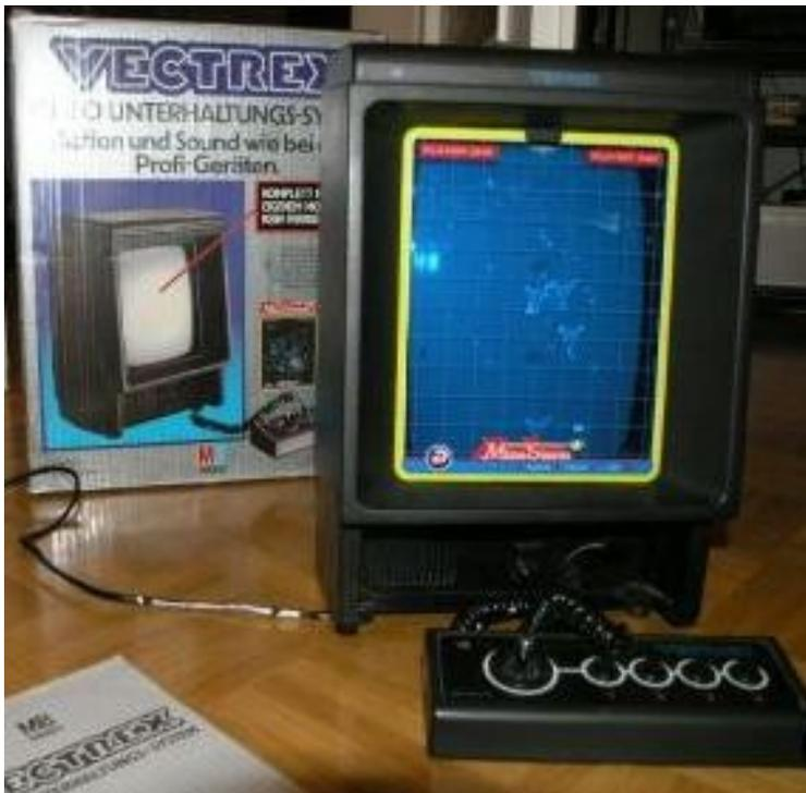
Das Vectrex ist eine Spielkonsole, die 1982 auf den Markt kam. Auffälligstes Merkmal ist der eingebaute Hochformat-S/W-Bildschirm zur Ausgabe der Vektorgrafik. Dieser Kompaktaufbau führte zur Einstufung durch Fachzeitschriften in eine eigene Kategorie: Mini-Arcade.
